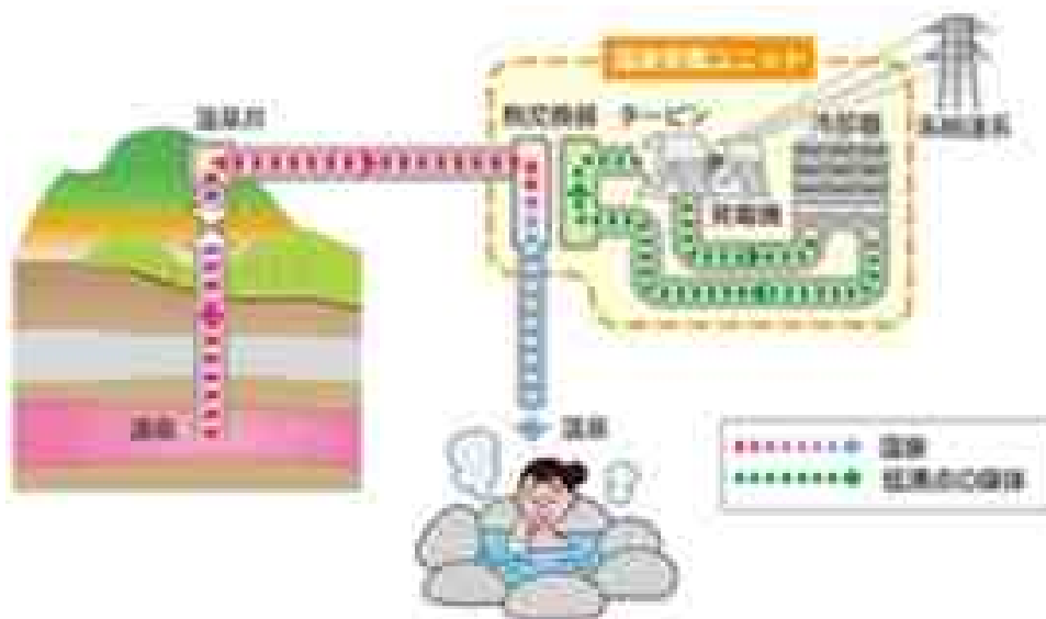
【図-1】 バイナリーサイクル発電イメージ図
